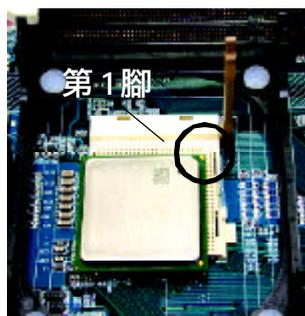
4. 將處理器的第一腳(金色三腳記號處)對準插座上的缺腳記號再將處理器插入插座。處理器插入定位後，再將連桿向下按至原位。◀
