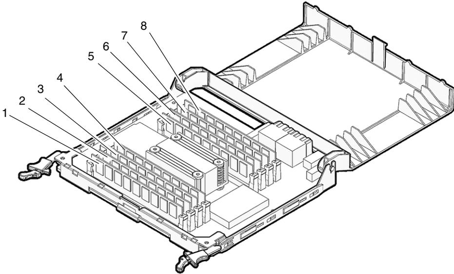
圖 1 記憶體板 DIMM 插槽編號
