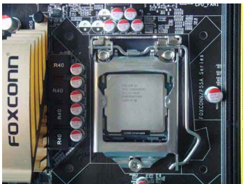
5. 当CPU安装妥当后，合上承载上盖，将承载杆恢复原位。
