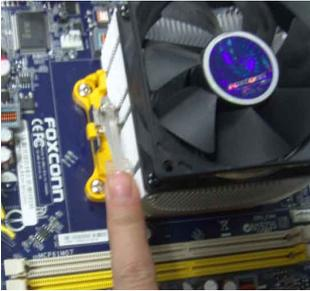
3. 扣住散热风扇的另一边，并按下加固杆来固定散热风扇。
