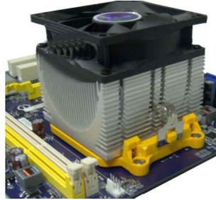
2. 将散热风扇牢固地扣在脚座的一边。
