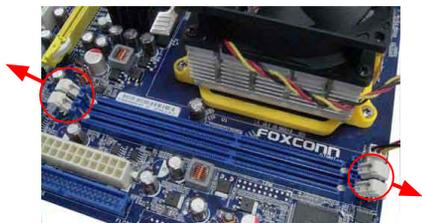
1. 扳开插槽两边的卡扣，将内存条以正确方向插入插槽，用手指垂直向下按压以使其牢固。
