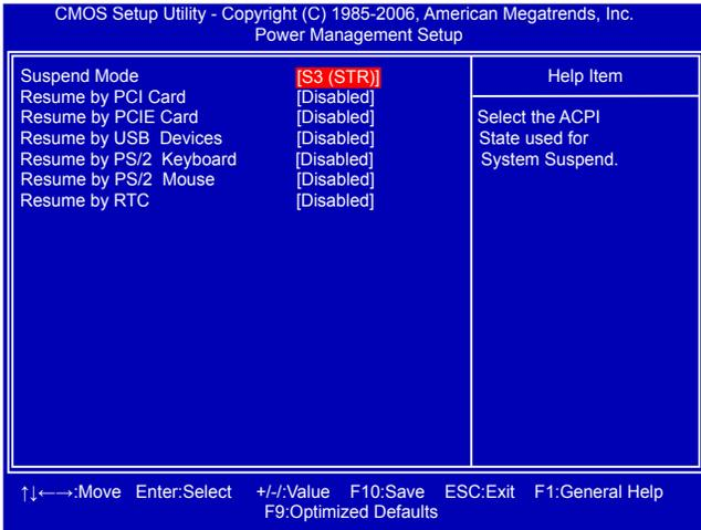
ACPI即高级配置和电源管理接口(Advanced Configuration and Power Management Interface)。ACPI定义了操作系统(支持ACPI, 如 Windows 2000, Windows XP)、BIOS和系统硬件之间的新型工作接口。这些新接口包括允许这些操作系统控制电源管理和设备配置的机制。
