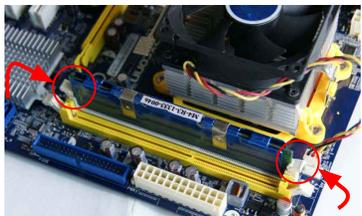
2. 内存条正确插入后，两端卡扣会自动卡上。
