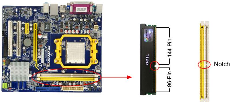
内存条中部有一个缺口，将针脚分为不对称的两部分，因此，内存条仅能以一个方向安装。请根据如下步骤正确安装内存。
