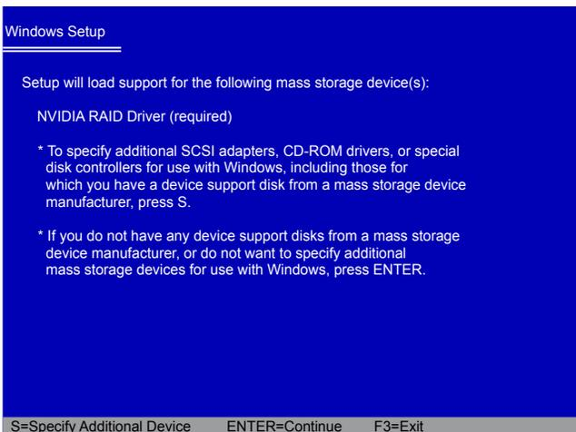
9. 使用[↓]键选择 “NVIDIA nForce Storage Controller (required)”，然后按下[Enter]键。此时第一张RAID 磁盘仍在软驱中。
