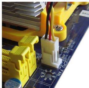
4. 连接散热风扇插头到主板上的CPU风扇接头。
