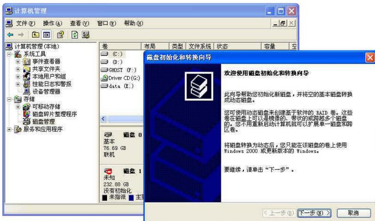
8. 屏幕将出现“选择要初始化的磁盘”窗口，硬盘列表依据您创建的RAID磁盘阵列数目。选择“磁盘1”并点击“下一步”继续。
