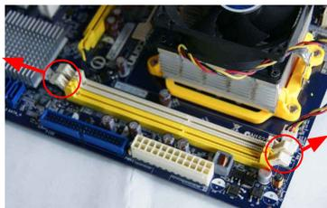
1. 扳开插槽两边的卡扣，将内存条以正确方向插入插槽，用手指垂直向下按压以使其牢固。
