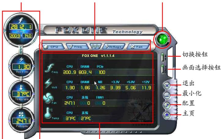
频率，电压，风扇转速，温度监控值
