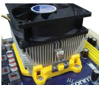
2. 将散热风扇牢固地扣在脚座的一边。
