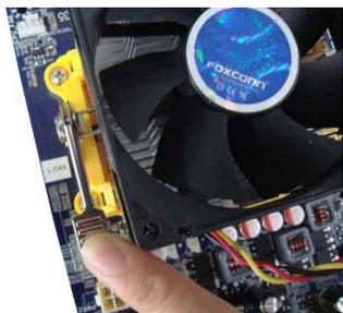
3. 扣住散热风扇的另一边，并按下加固杆来固定散热风扇。
