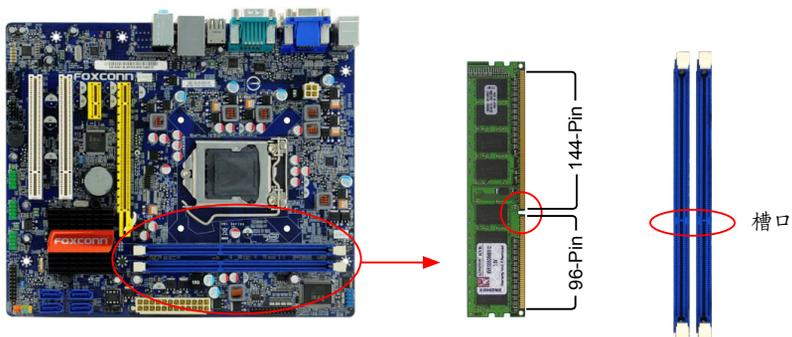
内存条中部有一个缺口，将针脚分为不对称的两部分，因此，内存条仅能以一个方向安装。请根据如下步骤正确安装内存。
