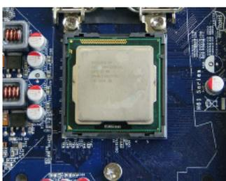
4. 将CPU的金三角标记对准插座上的针脚1位置，CPU的缺口对准插座凸缘，然后将其轻放入插座中。
