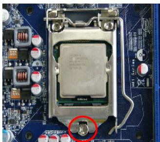
5. 当CPU安装妥当后，合上承载上盖，将承载杆恢复原位。
