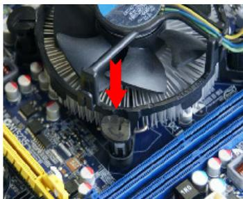
2. 将CPU风扇的四个定位柱分别对准主板定位孔，从上垂直向下按压定位柱顶部，便可将其固定在主板上。
