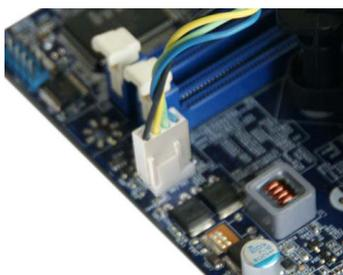
4. 连接散热风扇插头到主板上的CPU风扇接头。
