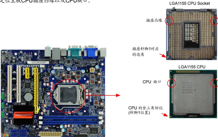
请根据如下步骤将CPU安装到CPU插座:
