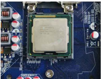
4. 将CPU的金三角标记对准插座上的针脚1位置，CPU的缺口对准插座凸缘，然后将其轻放入插座中。
