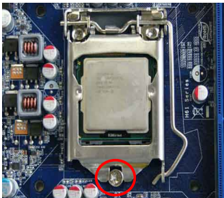
5. 当CPU安装妥当后，合上承载上盖，将承载杆恢复原位。
