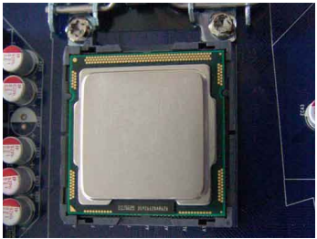
4. 将CPU的金三角标记对准插座上的针脚1位置，CPU的缺口对准插座凸缘，然后将其轻放入插座中。
