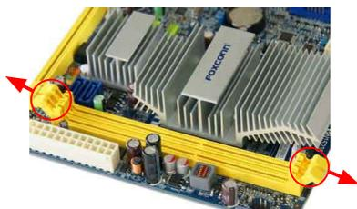
1. 扳开插槽两边的卡扣，将内存条以正确方向插入插槽，用手指垂直向下按压以使其牢固。
