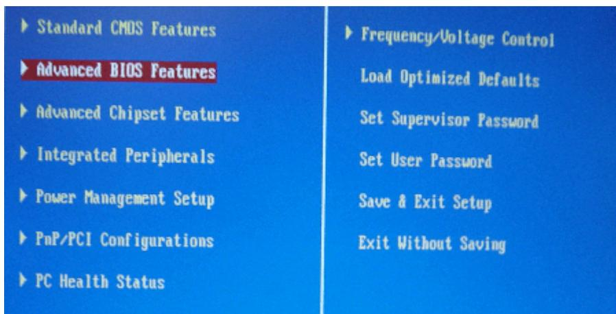
在这个界面下，您可以利用上下左右四个方向键来移动所选择的项目，利用回车键进入下面一级的子菜单，然后可以利用“Page Up”和“Page Down”键对各个参数进行修改。
