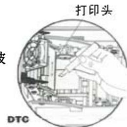
打印机驱动轮在每换一卷或是打印 250 张卡后应该进行清洁，如果打印机驱动轮表面看上去很脏也要及时的进行清洁。请在打印机电源开启的状态下按照下列步骤对打印机驱动轮进行清洁。
