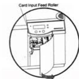
1. 打开进卡仓，取出里面的卡片，找到两个进卡驱动轮。
