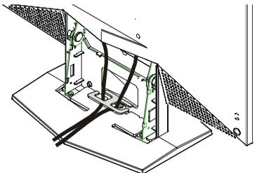
2. 重装盖板时，先装下面，然后将上面推入，听到“卡塔”声为止。如图所示：
