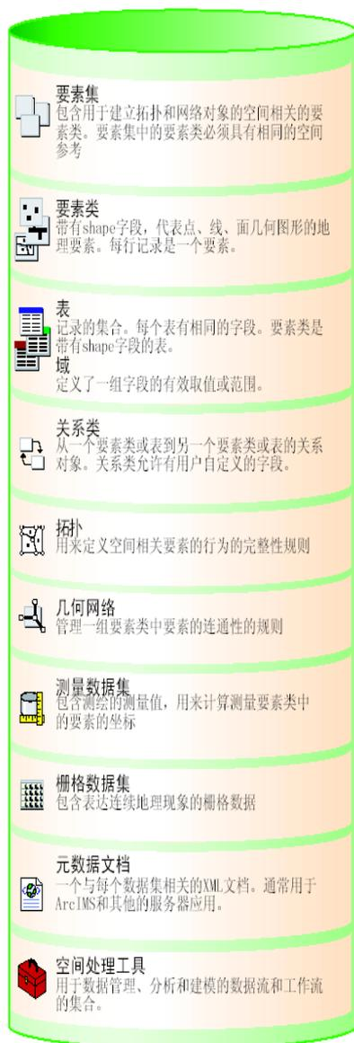
Geodatabase 实现在关系型数据库中存储地理数据。在标准的 DBMS 表中用标准的 SQL 数据类型存储和管理所有的地理元素。图中列出了用于开发地理数据模型的一些 Geodatabase 的结构元素。
