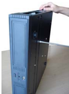
⑤将装好的硬盘固定在硬盘录像机中
