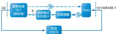
上行突发信号接收灵敏度和过载功率测试配置二
