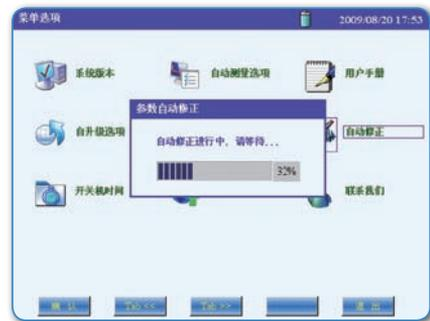
使用一段时间后，如发现测试结果有一定偏差，可用自动修正功能对仪表进行自校准。
