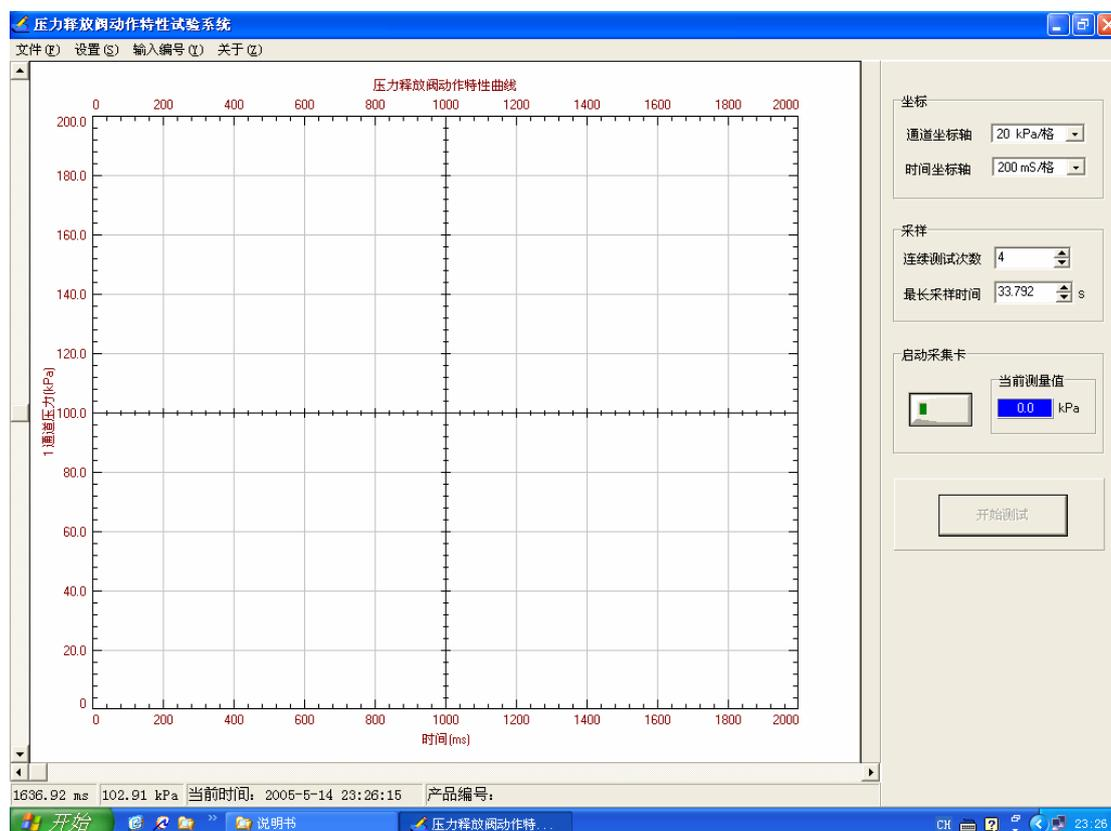
左侧的区域是波形的显示区。蓝色的曲线为试验罐中的压力曲线。曲线可以通过波形显示区左侧的滚动条上下移动。时间轴方向可以通过波形显示区下部的滚动条左右移动。
