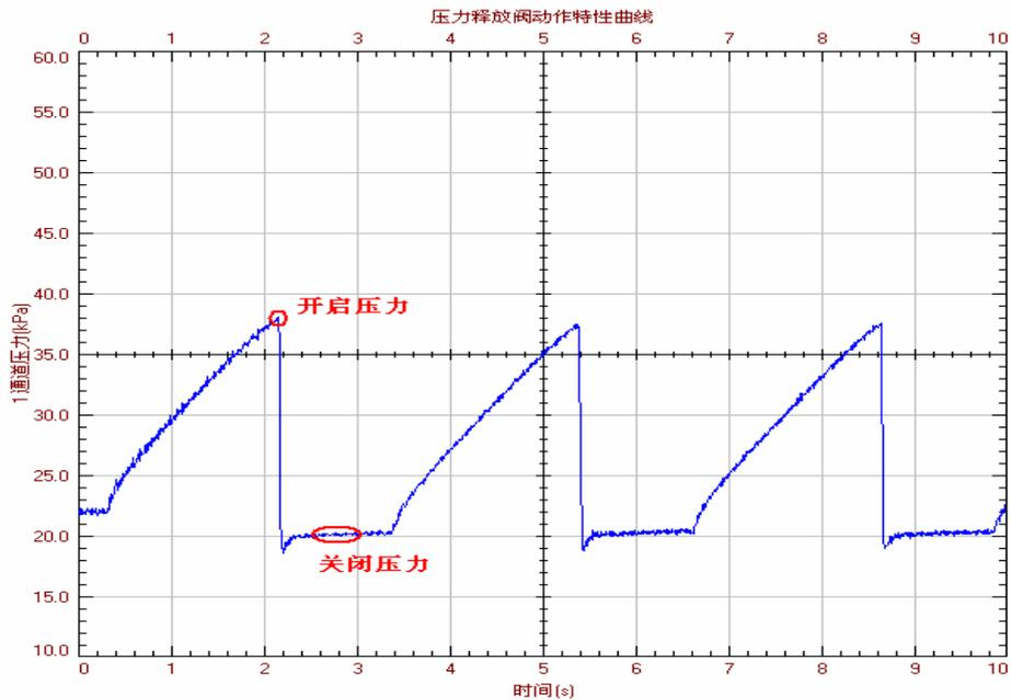
通过调整时间轴坐标和压力轴坐标可以放大曲线，进而观察曲线细节部分。将波峰处放大后可以读出释放阀的开启时间。见下图：
