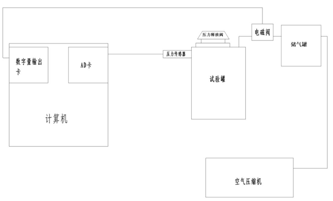
由于采用了计算机测控技术，本装置可以精确测试压力释放阀的动作特性，彻底解决了传统使用指针表测试方法中误差大，不能描述动作压力曲线的弊端。本装置可以对压力释放阀的开启压力、关闭压力、开启时间、密封压力值的密封性能进行试验与测量。并具备数据储存打印功能。由于采用了高频动态压力传感器，高速率的数据采集卡，高性能的
