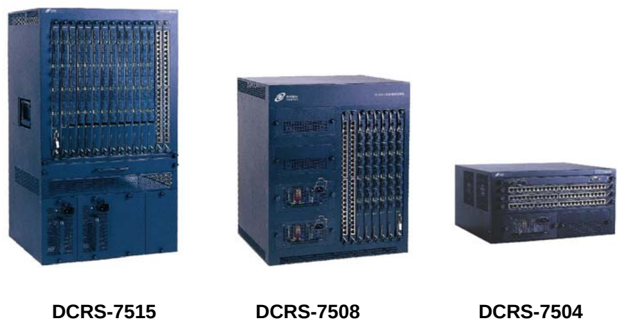
图 1.1 ：DCRS-7500 交换机的 3 种机箱规格
