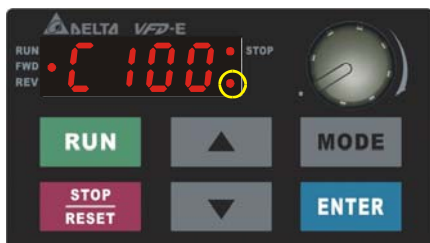
显示 1000~9999 时，只会显示前 3 个字符，而且右下方 LED 灯会亮起，表示显示值乘以 10 倍，如图中所显示的值表示为 1000~1009
