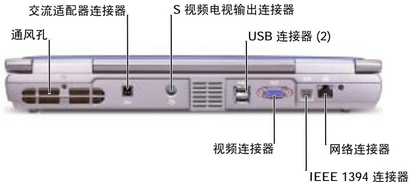
**通风孔** — 计算机使用内部风扇使空气经通风孔流通，从而防止计算机过热。
