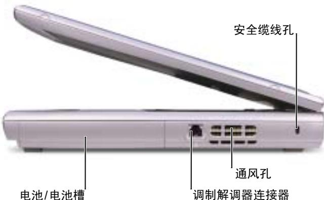
**电池/电池槽** — 在电池槽中安装电池后您即可使用计算机，而不必将计算机连接至电源插座。请参阅第 41 页。
