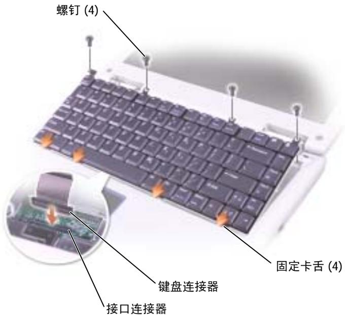
9 将键盘上的四个固定卡舌分别插入掌垫中相应的插槽，并将键盘向下按入底座。
