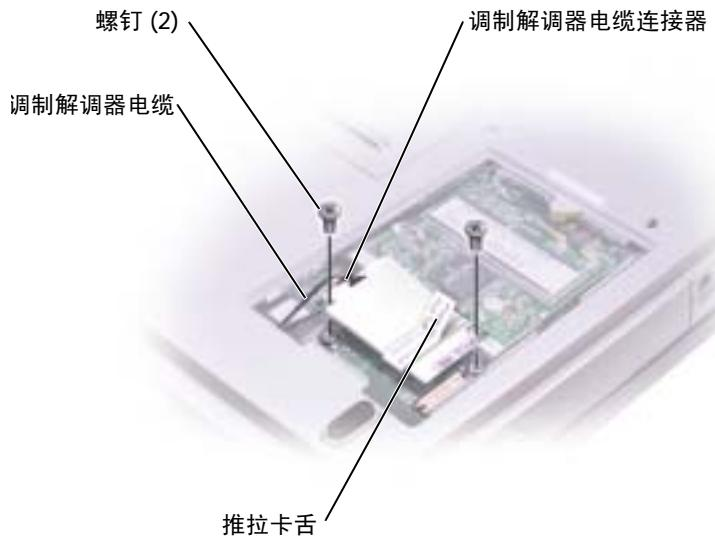
2 将调制解调器电缆连接至调制解调器。
