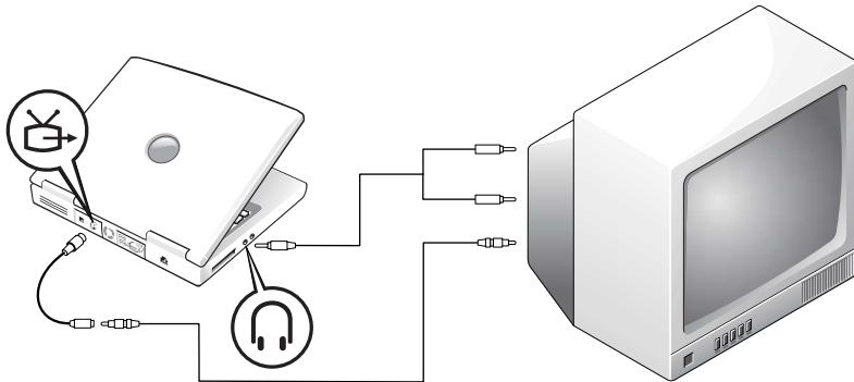
要将计算机连接至仅带有复合视频输入的电视，请使用复合电视输出适配器电缆。开始之前，请确保备有以下电缆：
