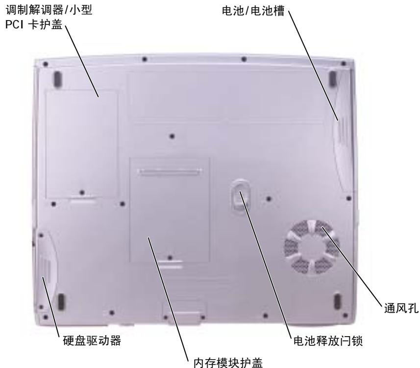
**调制解调器/小型 PCI 卡护盖** — 用于保护安装调制解调器和小型 PCI 卡的凹槽。请参阅第 99 页。
