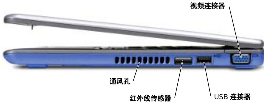
**红外线传感器** — 使您无须使用电缆连接，即可将文件从计算机传输至其它 IrDA 兼容设备。
