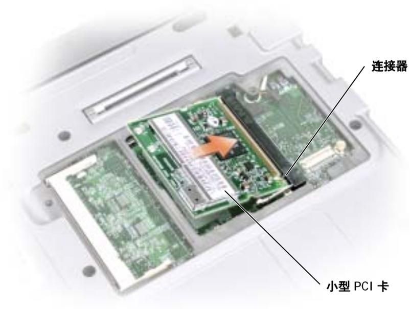
10 将天线电缆连接至小型 PCI 卡上的天线连接器。
