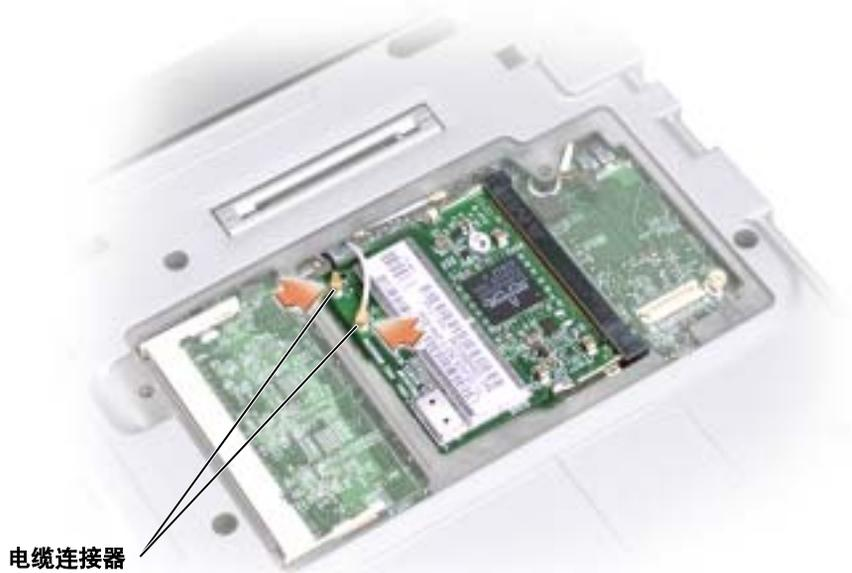
11 将小型 PCI 卡向内部卡舌方向压低至大约 20 度角。
