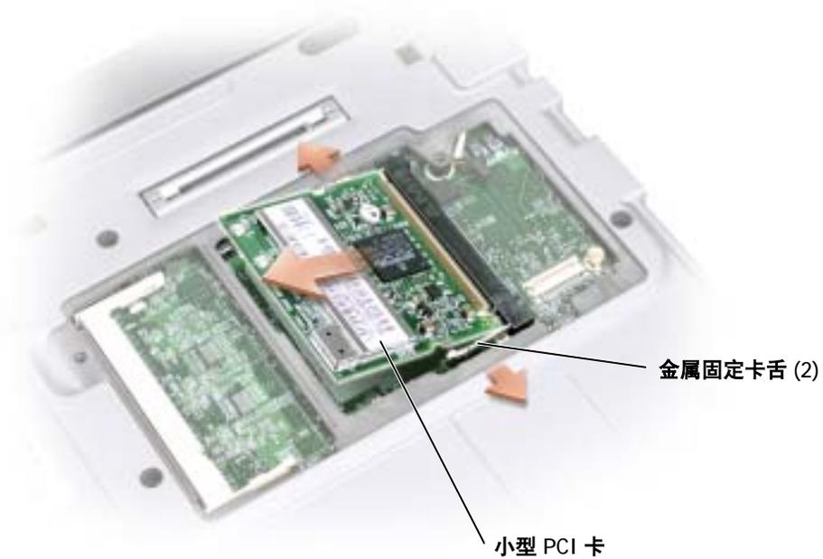
c 从小型 PCI 卡连接器中提起小型 PCI 卡。
