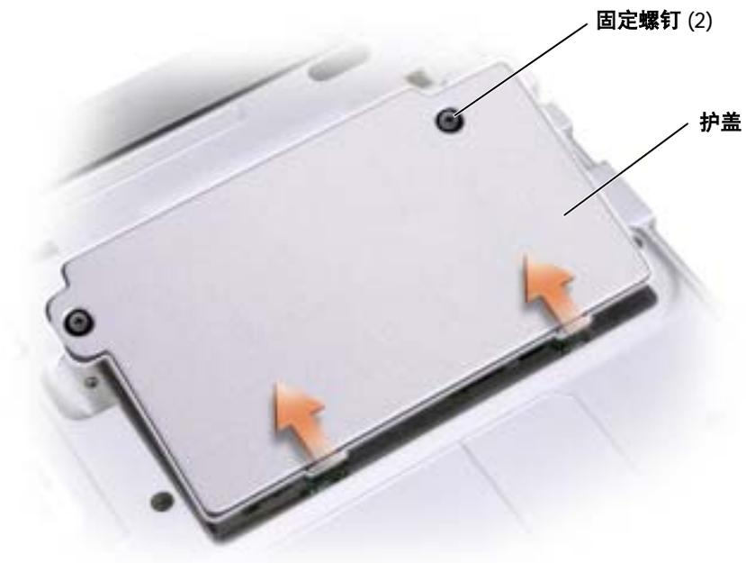
8 如果尚未安装小型 PCI 卡，请转至步骤 9。如果要更换小型 PCI 卡，请卸下现有的 PCI 卡：
