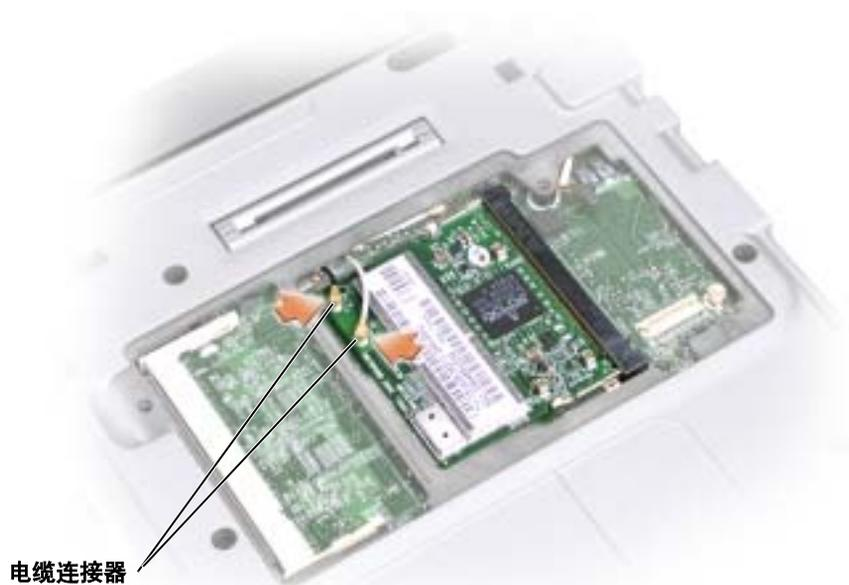
b 松开小型 PCI 卡，方法是掰开金属固定卡舌，直至 PCI 卡轻轻弹起。
