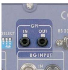
搭配洋銘科技 CKL-100 LED 環型投射燈控制器，可以透過 GPI 控制（或是被控制）選擇去背機切換 CAM-1 (Green) 或 CAM-2 (Blue)，亦或連接外部控制設備。
