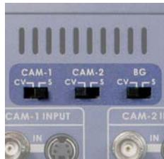
輸入選擇開關可以選擇 CV(類比) 或 S 端子，在條件允許的情況下最好使用 S 端子。
