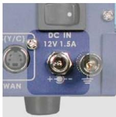
直流輸入。連接電壓器的直流，在電源插口上有一個旋鈕可以把插頭固定在上面確保不會掉落。
