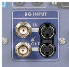
背景的素材来自于你给它的信号。例如 VRT 或 DVD。复合和 S 端子的输入在上面，下面是环路的输出。如果有需要的话 S 端子的输入可以通过复合的输出来预监，在 S 端子输入的情况下 S 端子的输出可以灵活的使用。
