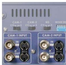
CAM-1 (綠) and CAM-2 (藍) 影像輸入連接兩個前景影像圖像。有類比和 S 端子輸入，並且每組輸入都設有一路迴路輸出。如果有需要的話 S 端子的輸入可以通過類比的輸出作為監看。在 S 端子輸入的情況下 S 端子的輸出可以靈活的使用。
