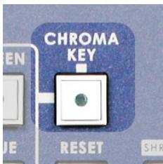
抠像按钮控制抠像的开和关，关闭功能时前景画面（CAM-1 或 CAM-2）会直接在监视器上显示。当开启该功能时，功能按钮会和连带的抠像按钮同时亮红灯（GREEN、BLUE、LUMA）具体看下文。
