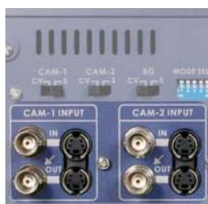
CAM-1 (绿) and CAM-2 (蓝) 视频输入连接两个前景视频图像。有复合和 S 端子输入，并且每个口都设有一路环路输出。如果有需要的话 S 端子的输入可以通过复合的输出来预监。在 S 端子输入的情况下 S 端子的输出可以灵活的使用。
