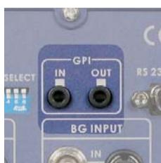
搭配着洋铭科技 CKL-100 LED 环型投射灯控制器，可以透过 GPI 控制（或是被控制）选择抠像机切换 CAM-1 (Green) 或 CAM-2 (Blue)，亦或连接外部控制设备。
