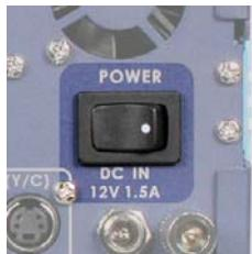
电源开关；控制 DVK-100 的电源启动 / 关闭。
