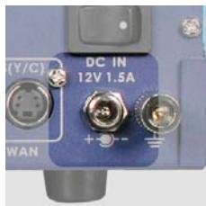
直流输入。连接适配器的直流，在电源插口上有一个旋钮可以把插头固定在上面确保不会掉落。DVK-100 也可以接一个 12V 的电池组，不过请确定电池组的电压。
