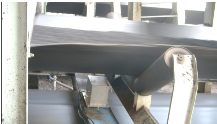
上图：燃煤电厂输煤皮带中的煤块水分检测
