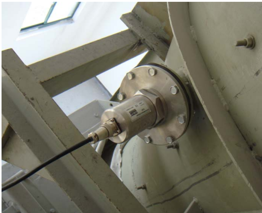
上图：浙江嘉兴玻璃厂石英砂水分测量
