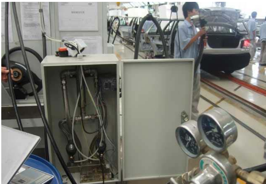
上图：一汽大众刹车油水分检测，0-0.5%量程
