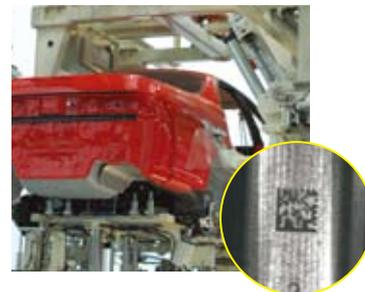
元件水平的代码读取...在该应用中，读取在喷油嘴上采用激光蚀刻的一个二维代码。
