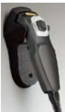
这种通用的支架使DataMan700系列读码器适合各种不同的放置方式。
