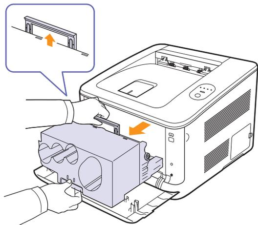
6 打开新成像装置的包装。取下成像装置两侧的保护装置，并撕掉保护其表面的包装纸。
