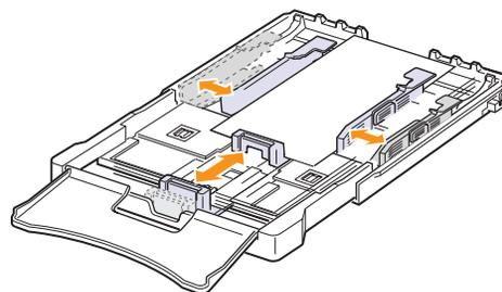
如果需要打印的纸张长度不足 222 毫米（8.74 英寸），按下并打开纸盘导轨锁，手动推回纸盘。调整纸张长度导轨和纸张宽度导轨。
