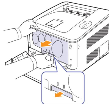
5 拉开成像装置顶部的手柄，利用它将成像装置从机器中完全拉出。
