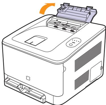
5 打开内盖板，小心地取出打印机中的卡纸。然后，内盖板会自动关闭。
