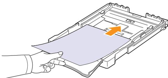
2 根据打印介质位置来调整纸张导板，注意不要使介质弯折。
