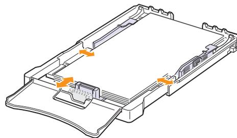
对于比 Letter 尺寸小的纸张，将纸张导轨退回原位置，并调整纸张长度导轨和纸张宽度导轨。
