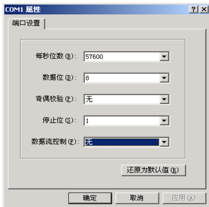
图 3.4 串口方式登陆无线路由器时参数设置示意图
