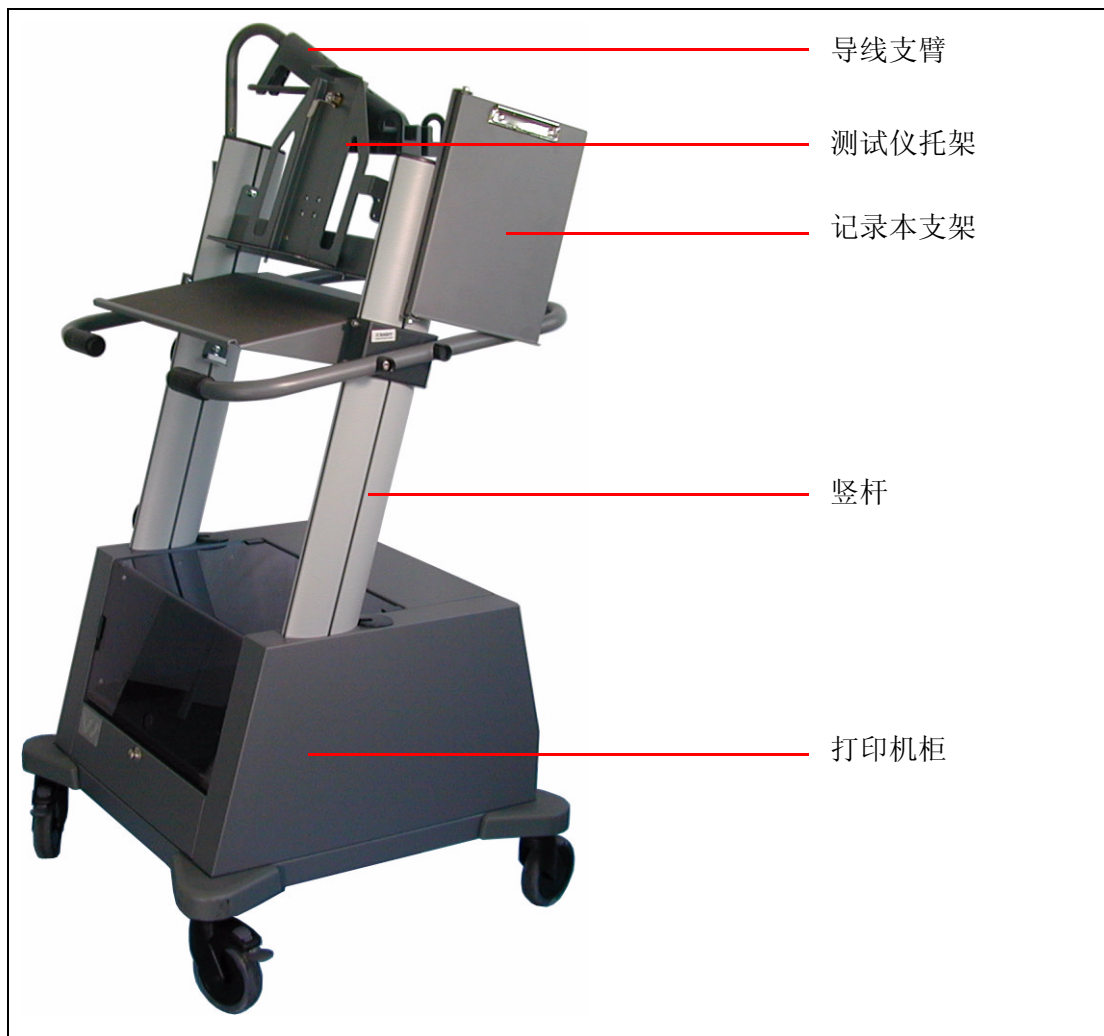
图 3-1 未进行装备的 Knuerr 公司机修车，导线支臂呈摆回状态
