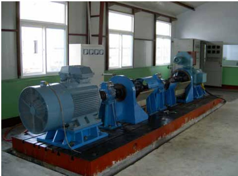
电力测功机在变速箱试验台上应用
