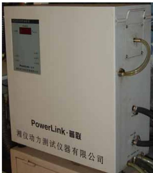
电喷发动机在试验过程中由于回油温度高，油料中混有大量气泡，直接导致油耗测量重复性差，油耗偏小，当燃油温度高到一定程度时甚至无法进行正常的油耗测量。FC2410 电喷发动机回油处理装置主要功能是对高温燃油进行冷却、消泡处理，使回油降温，气泡得以排除，从而提高油耗测量的准确性和重复性。该装置对发动机回油的处理过程完全由单片机系统实现，包括燃油温度的测量、消泡排放阀的开启等。该系统与 FC2210 智能油耗仪配套使用时的油耗测量精度可以达到  $\pm 0.4\%FS$ 。
