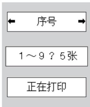
⑦ 请务必确认“正在打印”提示信息消失，送带停止后，再按色带切刀键。
