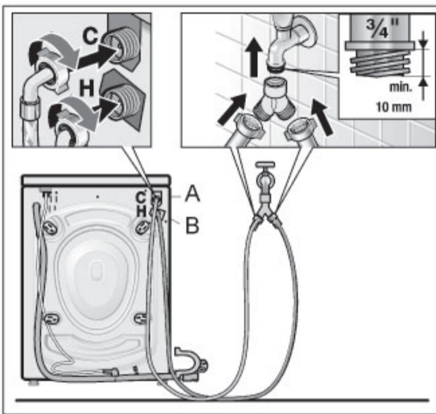
冷、熱水管連接後，請將水龍頭完全打開，並檢查連接點是否完全密合。
