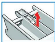
• 移除中央分隔器(如左圖下)：大拇指放在分隔器下方，將分隔器向上扳，即可卸下分隔器。請以清水及刷子清潔分隔器並擦乾。
