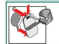
3. 裝上並栓緊搬運螺栓。搬運螺栓必須能嵌入機殼背板的溝槽內
