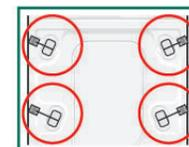
2. 預備搬運螺栓：將套筒內之螺絲鬆脫，直到螺絲尾端與套筒尾端齊平。
