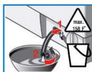
3. 將水管從固定處取下，卸下水管蓋，讓管內洗滌水排出，再蓋上蓋子。
