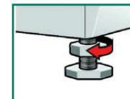
2. 旋轉機器腳以調整高度。洗衣機的**每一隻腳**都必須平穩地安置在地面上，機器不可以搖晃。請以水平儀校正機器水平。
