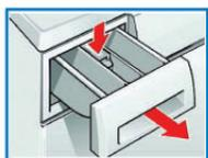
• 如左圖上：拉出洗劑添加槽，將柔軟精添加槽中央分隔器上之藍條向下壓，即可完全將整個添加槽卸下。
