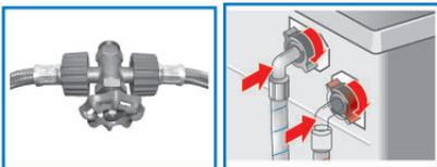
2. 進水管連接後，請將水龍頭完全打開，並檢查連接點是否完全密合。
