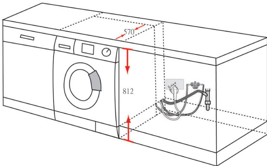
電源插座必須安裝於水槽櫃內，不可在洗衣機的後方，高度須在進水、排水接頭之上方。插座型式(附贈於配件箱內)請使用250V/20A之2極3線接地型插座。
