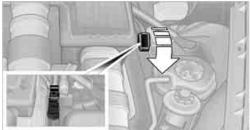
2. 将正极 / + 起动辅助电缆的一个电极夹钳接在供电汽车的蓄电池正极或起动辅助接线柱上。
