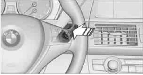
将遥控器插入点火开关直到限位位置。收音机待机位置自动接通。各个用电器工作准备就绪。
