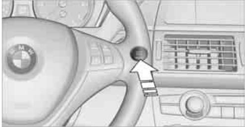
如果在踩下了制动器的情况下短促按压 Start/Stop（启动 / 关闭）按钮，便会启动发动机。 ◀
