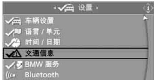
5. 必要时切换到最上面的栏位中。转动控制器，直到选定“TP”，然后按压控制器。
