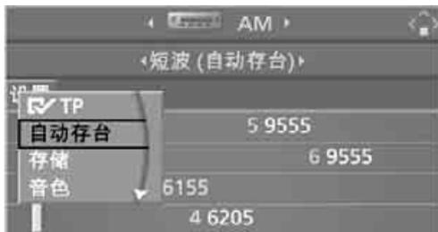
接收信号最强的电台显示随即更新。该电台的频率会显示出来。
