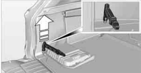
3. 把松脱工具（在底板下面的随车工具中，见第 181 页）插到开锁点上。
