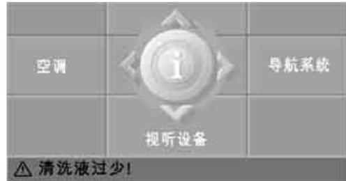
控制显示下边缘的文本信息用来解释亮起的指示灯和警告灯的含义。
