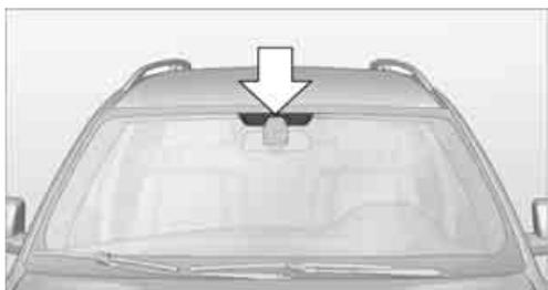
请将插图中标出的区域用于您的车库开门器、电子计费之类的装置。这个区域没有红外线反射涂层，从车内可以清楚地看到。
