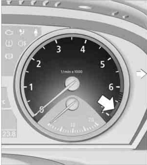
务必避免发动机转速处于红色警示区内，见箭头。在这个区域内为了保护发动机将中断燃油输入。
