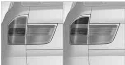
根据您脚踩制动踏板的力度而定，制动信号灯会分两级亮起：
