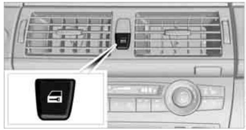
在前车门已关闭的情况下，用这个按钮可将所有车门和后行李箱盖上部开锁或上锁，但不会打开防盗安全装置。燃油箱盖板保持开锁状态\*。
