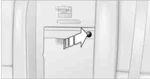
2. 重新按压按钮，行李箱内的盖板自动打开。如果第一次按压此按钮使用的力量较大，这个盖板也会随着自动打开。
