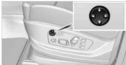
靠背的轮廓是可变的，因此可按照腰部脊柱的弧度（脊柱前凸）支撑乘员。
