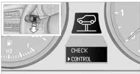
1. 把转向信号灯控制杆上的此按钮向下按压。显示屏上出现“CHECK OK”（检查正常）或已存储的检查控制信息。如果没有任何信息，显示的便是“CHECK OK”。检查控制信息与文本信息一起出现在控制显示上。
