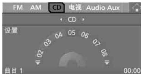
4. 必要时切换到从上往下数的第二个栏位。如果汽车带有 CD 换碟机，请选择“CD”，然后按压控制器，启动 CD 播放器。
