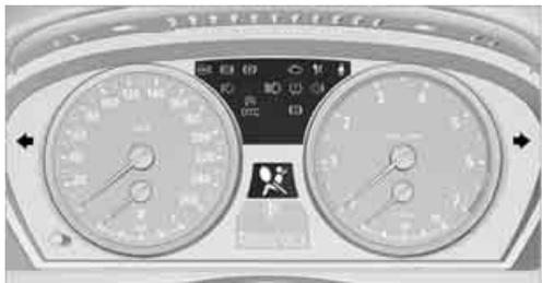
指示灯和报警灯能够以不同的组合和颜色亮起。在起动发动机或打开点火开关时，某些指示灯会进行功能检查而短暂亮起。
