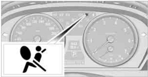
从收音机待机位置开始，见第 54 页，警告灯短时间亮起，由此指示整个安全气囊系统和安全带拉紧装置功能准备就绪。
