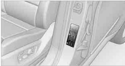
在打开驾驶员侧车门后，即可在车门柱上看到用于本车系列化轮胎的充气压力数据。
