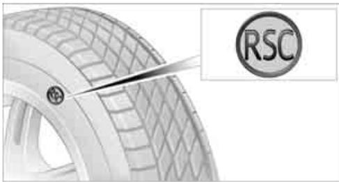
防爆轮胎的侧壁上有一个带“RSC”字样的圆形标记。
