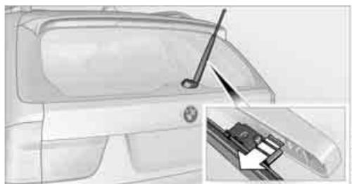
1. 将刮水臂完全抬起，然后拔出刮水片，如箭头所示。
