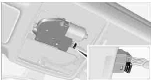
4. 从随车工具固定架上取出内六角扳手，见第 181 页，然后把它插入预设的开口中。将全景玻璃天窗朝需要的方向移动。
