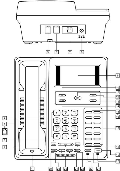
1、手柄绳插座 2、音量键 3、FLASH 键 4、数字键 5、数据线插座 6、话机线插座 7、振铃开关 8、电源插座 9、TFT 彩色液晶屏 10、UP 键 11、SET 键 12、OUT 键 13、DEL 键 14、DOWN 键 15、纸片 16、蒙片 17、速拨键 18、REDIAL 键 19、MON 键 20、监控指示灯 21、SPKR 键 22、免提指示灯 23、MUTE 键 24、PAUSE 键 25、信息灯 26、R 键 27、HOLD 键
