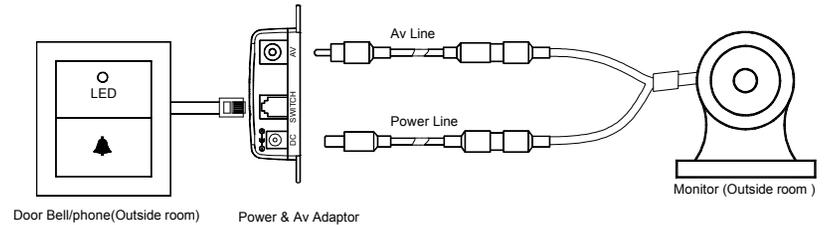
如上图示，将随机所附的六芯直线一端连接到话机前方的 DATA 插座，另一端连接到视频转接盒的 DATA 插座；然后按照上图所示的连线方法分别将墙壁内视频线、电源线、开关控制线（四芯 15 米）与摄像头、门铃开关正确连接，最后将随机配带的 DC12V（1000mA）电源（插头为内正外负）连接至话机前端的电源插座。
