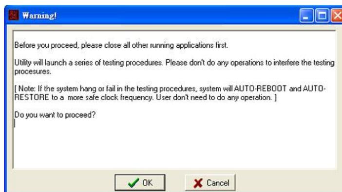
工具会进行一系列的检测直到系统失败。然后系统使用 Watchdog 功能进行安全错误重启。重启后，再次启动工具，加载先前验证过的最佳最稳定频率。
