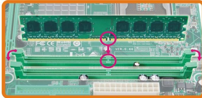
2. 垂直插入 DIMM 并固定好，直到固定夹跳回原位，DIMM 就位。
