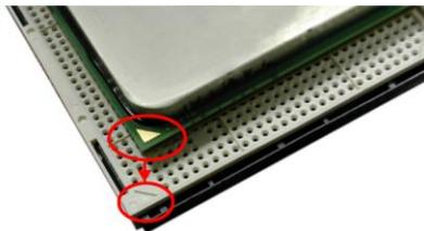
**步骤 4:** 固定 CPU，将拉杆闭合。
