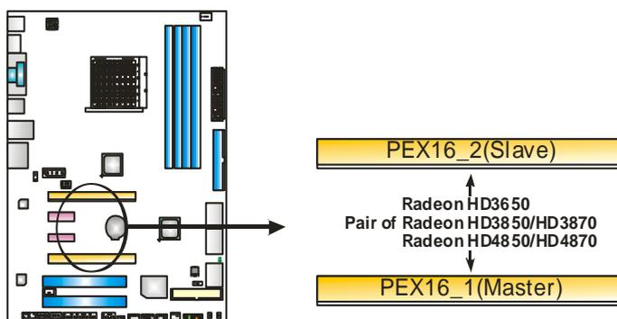
**注意:** 请确保两块显卡都完全插入插槽。
