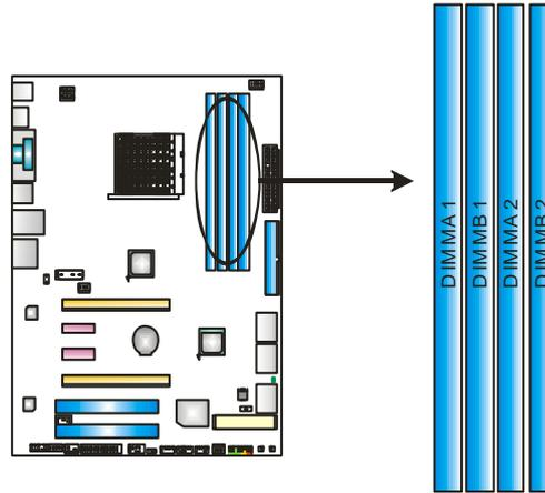
1. 向外推开固定夹，打开 DIMM 插槽。将 DIMM 按顺序放在插槽上，DIMM 上的切口须与插槽凹口匹配。
