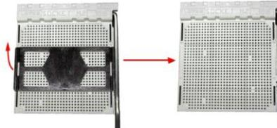
**步骤 2:** 将固定拉杆从插槽水平拉起至 90 度。
