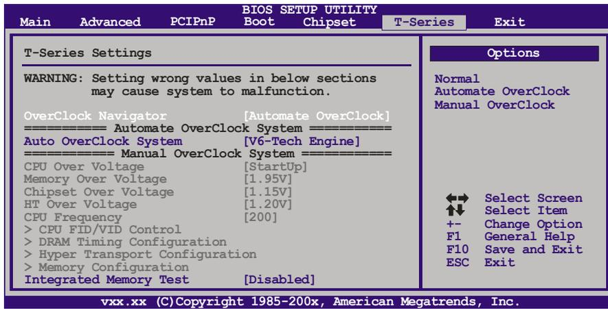
Overclock Navigator提供3个不同的引擎帮助系统超频。这些引擎将系统性能推进到不同的高度。
