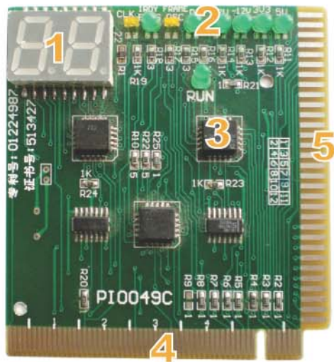
1、代码灯 2、状态灯 3、诊断芯片 4、PCI插槽 5、ISA插槽
