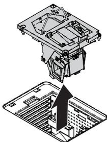
6. 将新灯泡插入灯泡舱，确保在投影机中安装到位。
