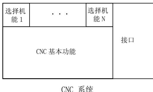
由此图可知，CNC系统由基本功能、选择机能、接口部分等组成，对不同的机床，其选择机能、接口设计不尽相同，所以对机床使用者来讲，请参阅机床厂家发行的说明书。
