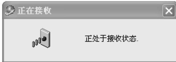
之后，操作连接的数控系统发送数据。在数据接收完毕后，接收到的数据显示在编辑框内。这时，可以点击菜单栏中『保存』或『另存为』菜单，保存或另存接收到的数据，也可以对接收到的数据进行更改后再次传送到数控系统。
