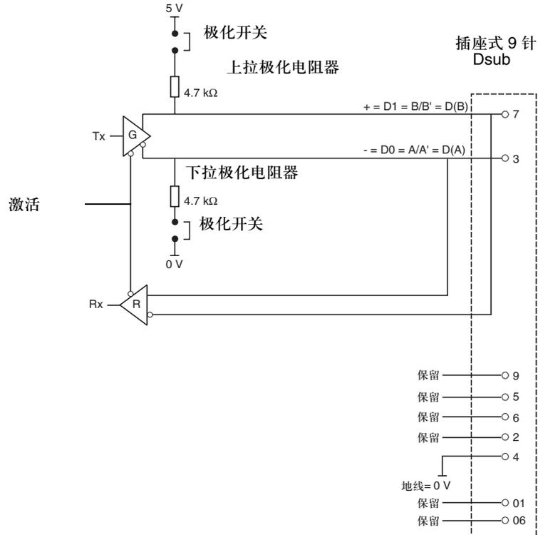
极化开关被用于连接或断开上拉与下拉电阻器。
