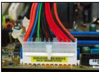
主板使用 24-pin 电源输入
