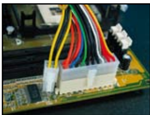
主板使用 20-pin 电源输入
