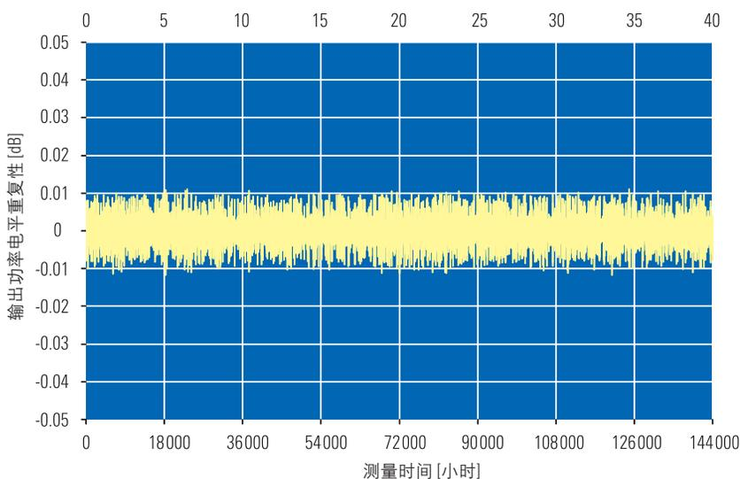
电平重复性随时间的变化（测量过程中随机改变频率和电平值）。
