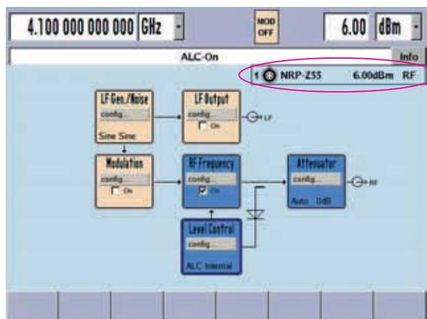
NRP-Z55功率探头连接至SMF100A射频输出端：测试结果显示在框图的右上角
