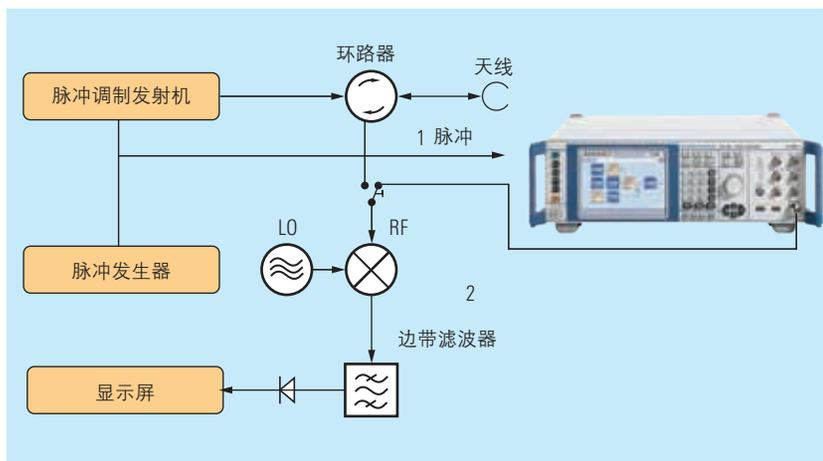
雷达设备的距离测试和天线方向显示
