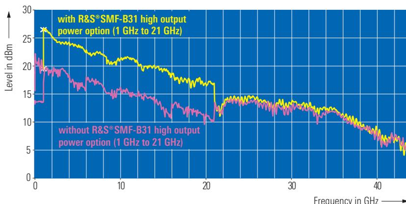
在 1 GHz 至 43.5 GHz 频率范围内使用和不使用高输出功率选件的最大输出功率（都使用 R&S®SMF-B27 步进衰减器选件）。下方的曲线在 100 kHz 至 1 GHz 的测量是使用 R&S®SMF-B2 频率扩展选件。
