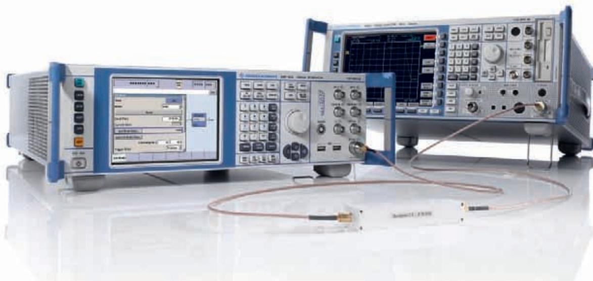
SMF100A微波信号源和加配FSP-B10选件的FSQ频谱分析仪进行的标量网络分析
