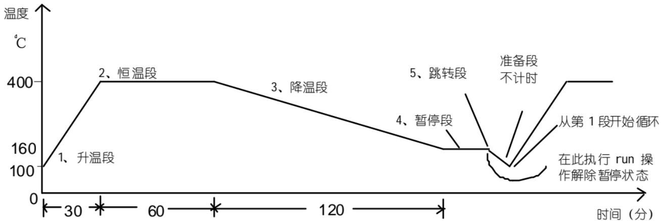
采用温度~时间编程方法的优点是升温、降温的斜率设置的范围非常宽。升温及恒温段具有统一的设置格式，方便学习。设置曲线更灵活，可以设置连续设置升温段(如用不同斜率的升温段近似实现函数升温)，或连续的恒温段。
