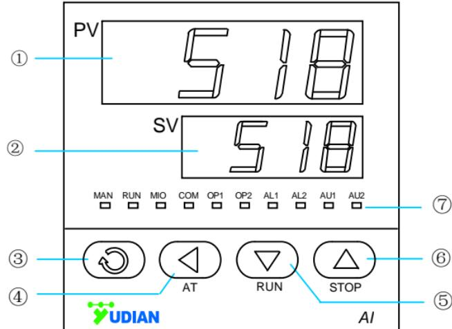
仪表上电后进入基本显示状态，此时仪表上、下显示窗分别显示测量值（PV）和给定值（SV），下显示窗还可交替显示以下字符表示状态：① “orAL<sub>i</sub>”，表示输入的测量信号超出量程；② “HIAL<sub>i</sub>”、“LoAL<sub>i</sub>”、“i HdAL<sub>i</sub>”或“i LdAL<sub>i</sub>”时，分别表示发生了上限报警、下限报警、偏差上限报警、偏差下限报警；③ “StoP<sub>i</sub>” 表示处于停止状态；“i HoLd<sub>i</sub>” 和 “i rdy<sub>i</sub>” 分别表示暂停状态和准备状态（仅AI-518P程序型仪表使用）。
