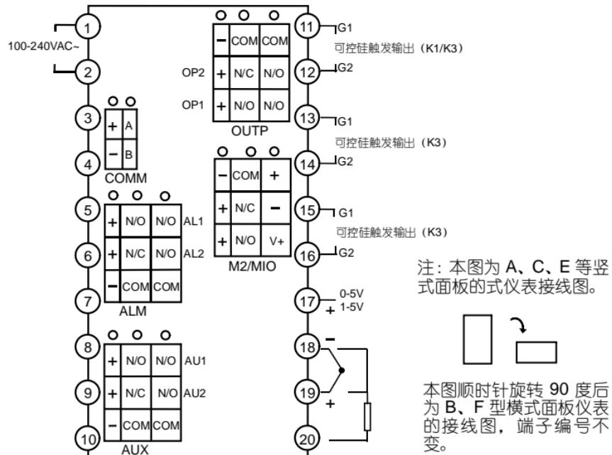
D型面板仪表 ( 72mmX72mm ) 接线图如下：
