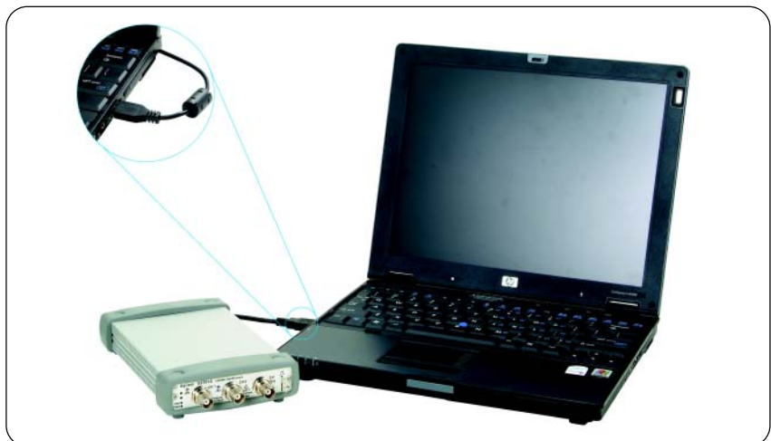
图 4. U2701A 和 U2702A 通过 USB 电缆与台式机或笔记本电脑相连,以实现快速的数据传输。
