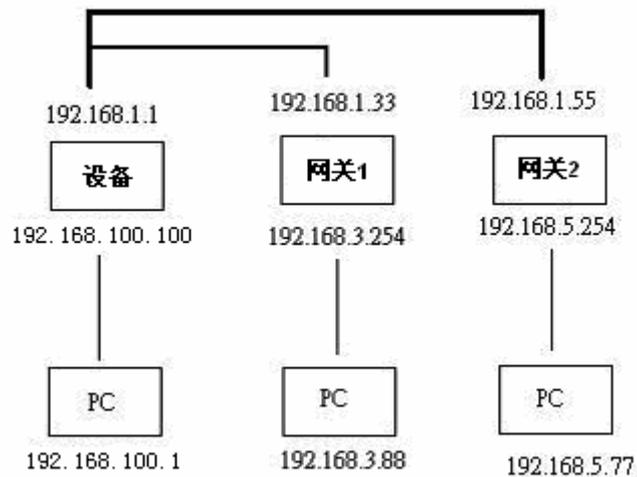
在这个例子中，主机需要发送 IP 数据报文到 192.168.3.88，上面的路由表的规则会让报文路由到 192.168.1.33(网关)，如果报文发送到 192.168.5.77 将被路由到 192.168.1.55。
