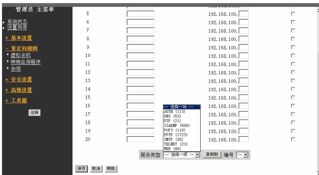
无线路由器的 NAT 防火墙过滤掉未被认可的包文，以保护你的局域网。这样在无线路由器后面的所有主机对于外界都是不可见的。可假如你希望，也能做到让一部分机器被
