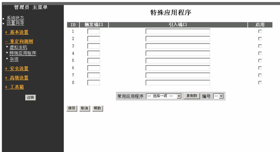
有些程序的运行需要多个连接，比如 Internet 游戏、视频会议、Internet 电话等。由于防火墙的存在，这些程序无法在单纯的 NAT 路由下工作。特殊应用程序功能允许一些这样的程序，透过无线路由器正常运作。假如特殊应用程序的机制仍不能使程序正常运行，试将你的工作站设置为 DMZ 主机。
