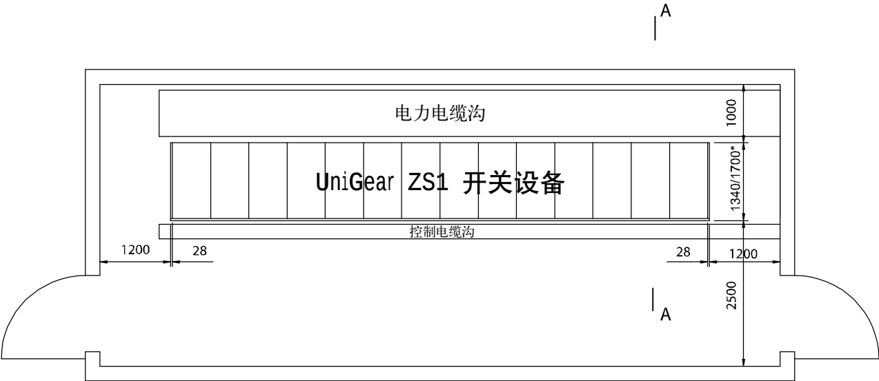
图 17.1 配电室典型平面布置图
