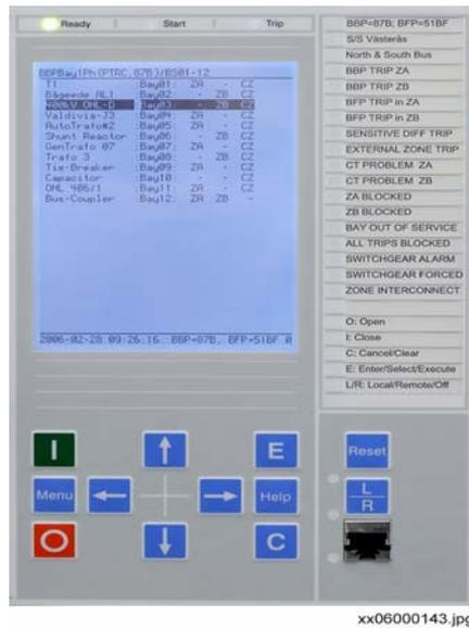
图 11: 中型 HMI 示例
