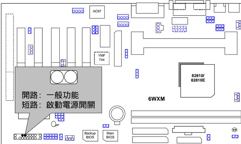
IR / CIR : 紅外線連接端 (Infrared Connector)
