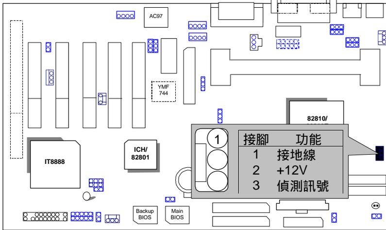
**SYSTEM FAN : System 散熱風扇電源接頭**
