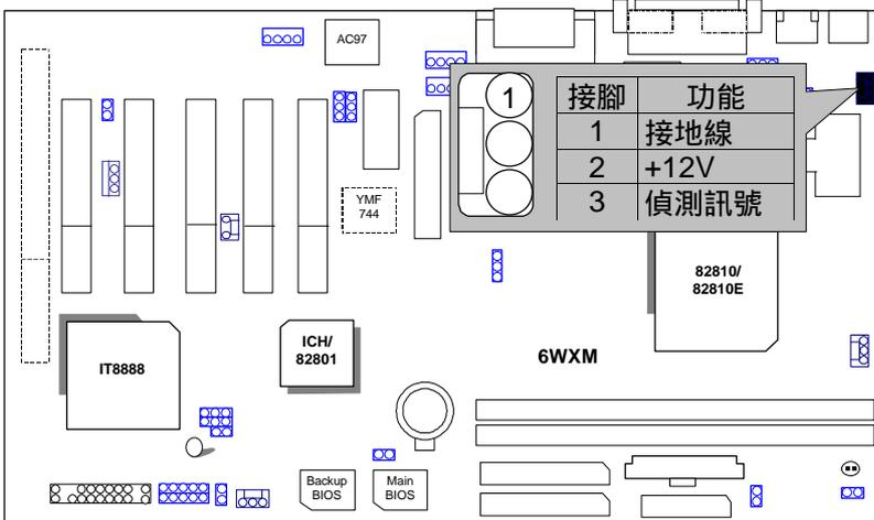
**PWR FAN : Power 散熱風扇電源接頭**
