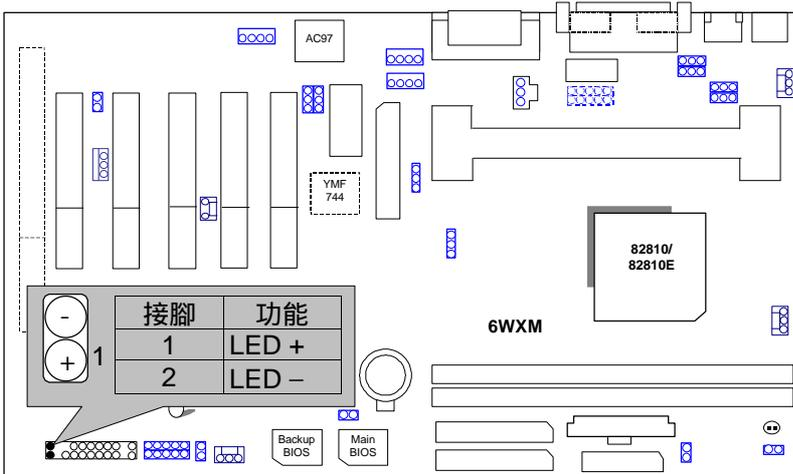
HD: IDE 硬碟指示燈 (IDE Hard Disk Active LED)
