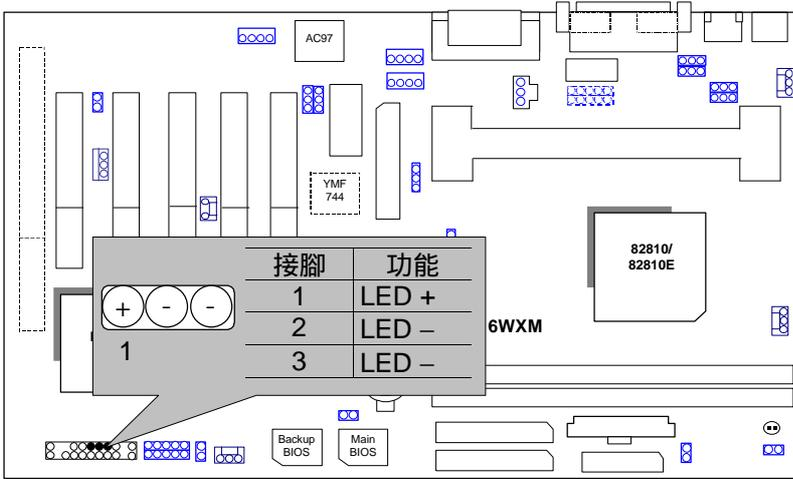
Soft PWR : 系統電源開關接頭 (支援ATX電源供應器)
