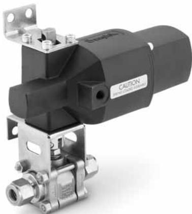
世伟洛克齿条齿轮气动执行机构结构紧凑、重量轻、易于安装，并在标准车间空气条件下操作。现可提供弹簧回复和双作用模式的执行机构。通-断(2通)阀需要90°执行；切换(3通)阀需要180°执行。
