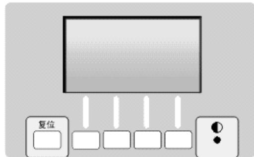
本机的显示器为  $128 \times 64$  点阵液晶显示器，电阻的测量值以及操作信息均通过它显示。
