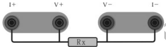
如上图所示，输出测量部分包括四只接线柱。其中 I+、I-为电流输出，V+和 V-为电压输入
