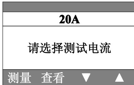
当确认待测负载和仪器可靠的连接好后，按屏幕显示的“▼”“▲”对应按键切换所需要的测试电流。
