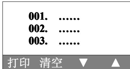
本仪器可存储 255 个数据，按下“打印”键存储的所有数据被全部打印出来。“▼”“▲”键可以上下翻看存储数据。按“清空”键可以删除所有数据，退出按“复位”键。
