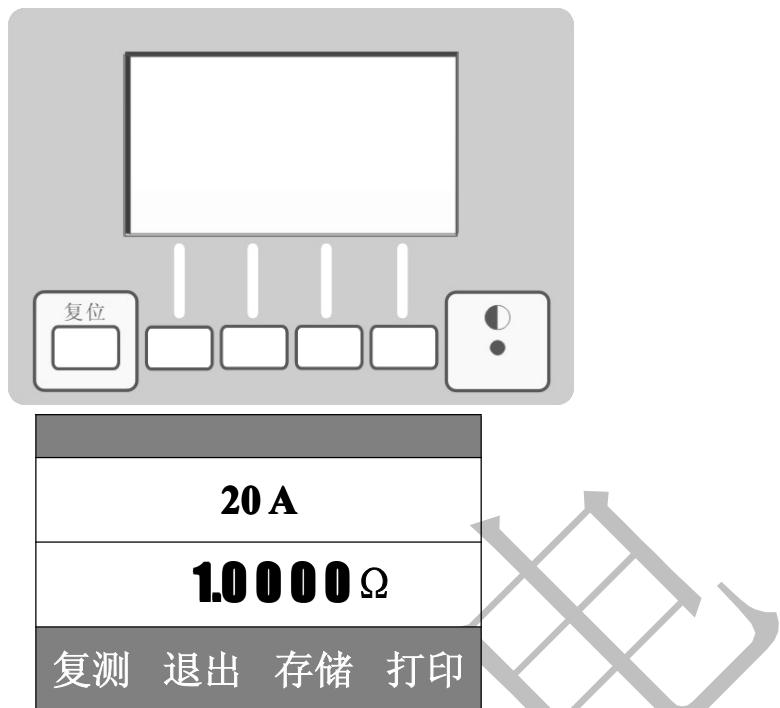
上图为液晶显示器和键盘组件组成的显示控制部分，其中显示器为点阵式液晶显示屏，用于显示操作提示、测量结果、以及指示显示屏下部 4 个多功能按键的用途。左侧的“复位”键可使仪器在出现死机或从菜单退出时直接返回到初始状态。最右侧的小孔为显示器对比度调节孔，在显示器出现显示图形对比度过深或过浅，影响阅读效果时，可以用小型“一”字改锥进行适当调节。
