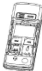
确保手机已经关机，卸下手机后盖与手机电池，将PIM卡的金属面向下，按照斜角向上的位置插入卡槽中，装上电池和手机后盖即可。
