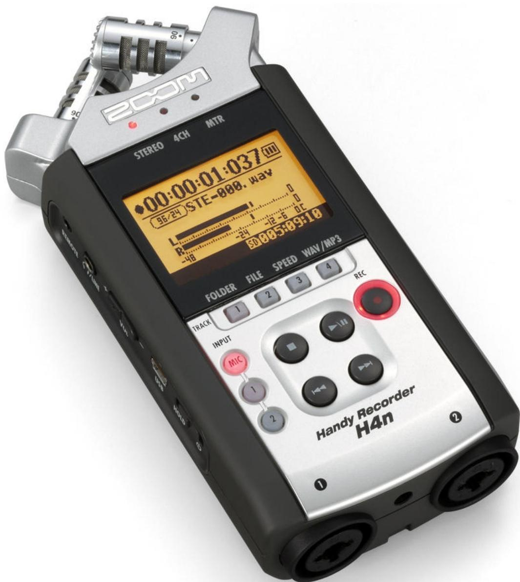
打开 H4n 你会发现它是一款小巧的录音设备，因为机体重量仅有 280g，完全可以收纳于手掌之中。H4n 是 H4 和 H2 的进化版本。内置扬声器可以直接回放而不必再戴耳机。SD/SDHC 记忆卡储存录音，具有 DSP 效果，外部电源或者 2 节 5 号电池即可供应长时间录音达 10 个小时的耐力模式（Stamina Mode）。对于环境和现场声音能够准确且丰富的表达。H4n 最高支持凌驾于 CD 音质的 24bit/96KHz 的线性 PCM 录音，录音格式以 WAV 或者 MP3 保存，可以通过自带的 USB 转送到电脑，对于不同的需求 H4n 都可以提供漂亮轻便的完美录音品质服务。
